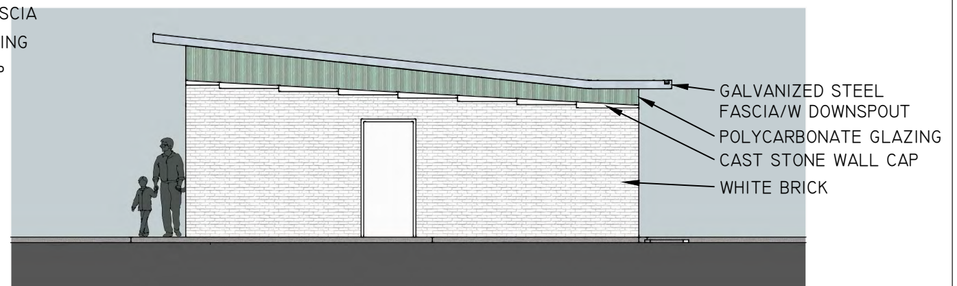
↑ 1 SOUTH ELEVATION SCALE: 1/8" = 1'-0"
