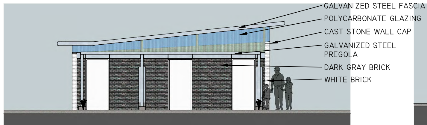
2 NORTH ELEVATION SCALE: 1/8" = 1'-0"
