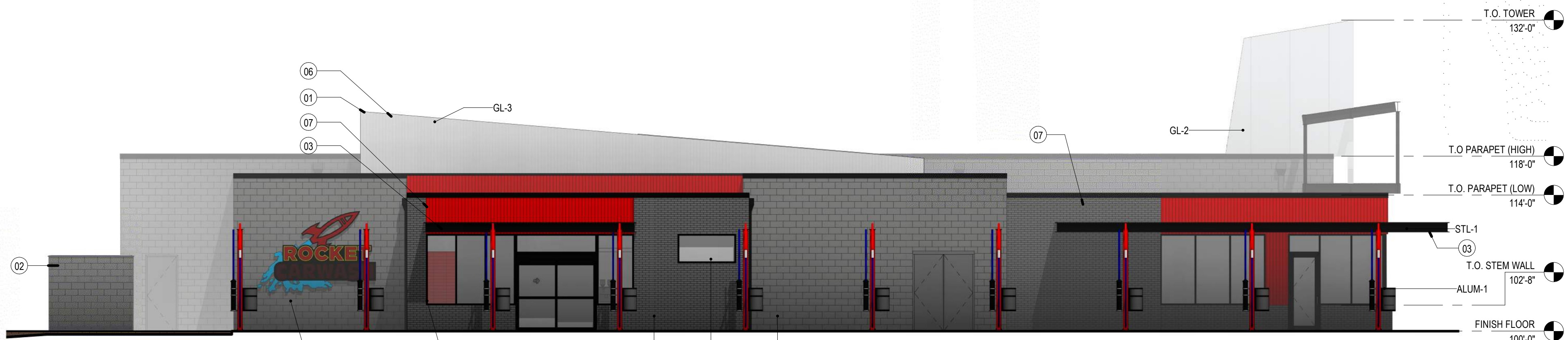
4 EXTERIOR ELEVATION - WEST A3 1/8" = 1'-0"
